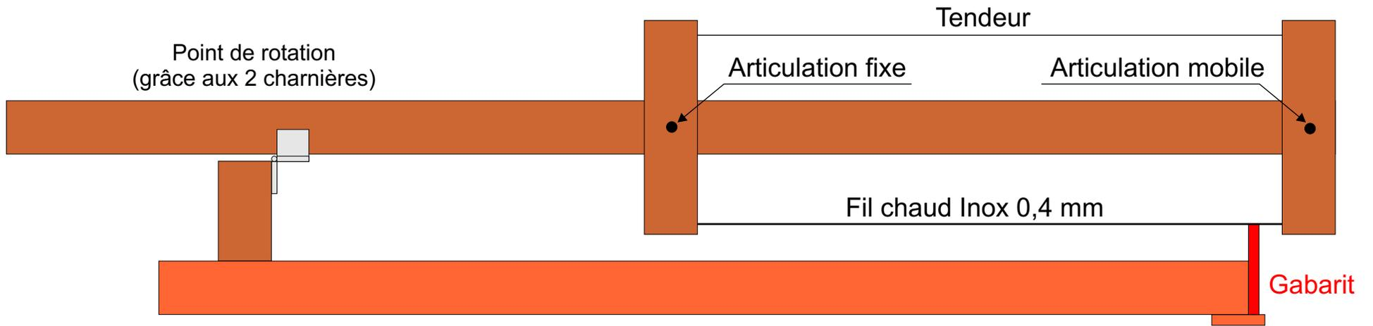
**Table de découpe d'aile automatique à pantographe by PYM**
